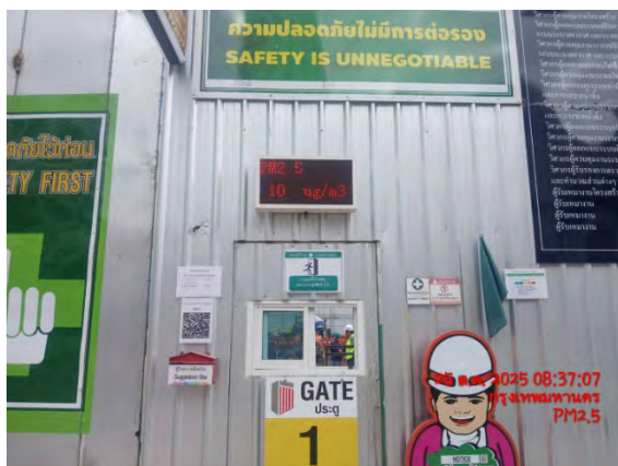
รูปที่ 2-16 เครื่องตรวจวัดคุณภาพอากาศ และฝุ่นละอองขนาดไม่เกิน 2.5 ไมครอน (PM-2.5) Real Time
