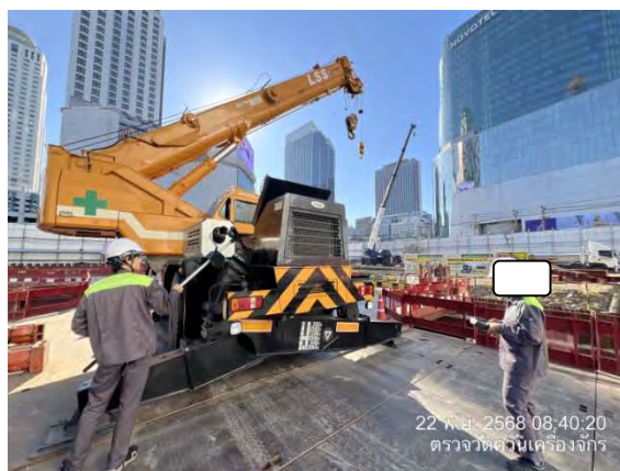
รูปที่ 2-18 เจ้าหน้าที่ตรวจสอบยานพาหนะและเครื่องจักร (ตรวจวัดควันดำเครื่องจักรและรถบรรทุก)
