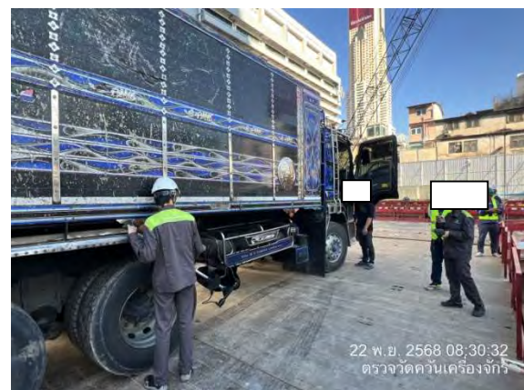
รูปที่ 2-18 เจ้าหน้าที่ตรวจสอบยานพาหนะและเครื่องจักร (ตรวจวัดควันดำเครื่องจักรและรถบรรทุก)
